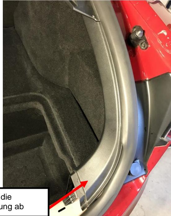
Hebeln Sie die Plastikverkleidung ab
