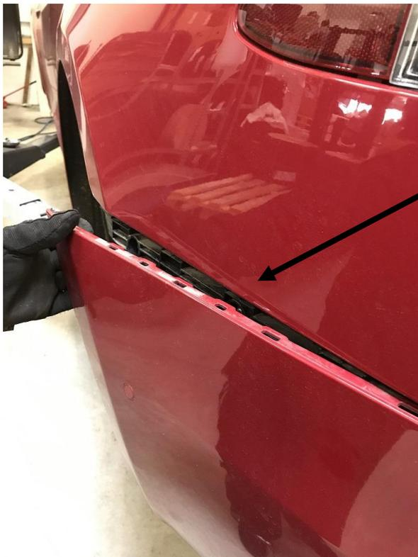
Ziehen Sie die Kotflügel
