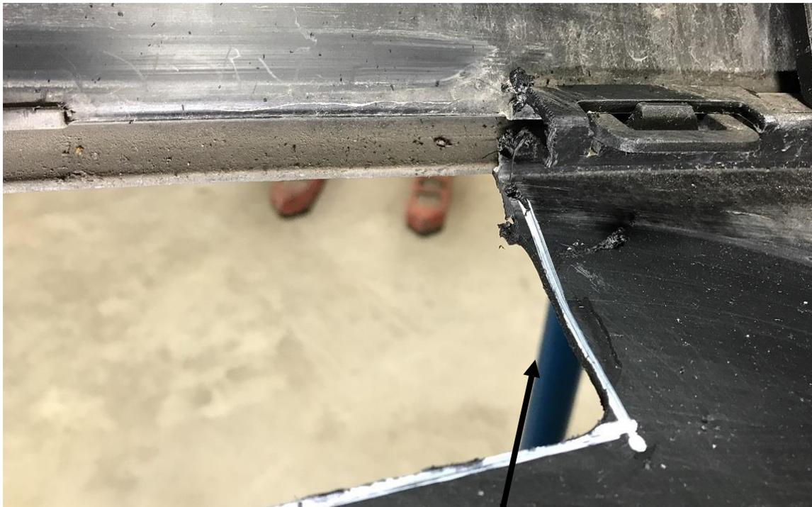
Nachdem das Heckteil wieder auf das Fahrzeug montiert wurde, kann der Ausschnitt problemlos von unten nachgearbeitet werden
